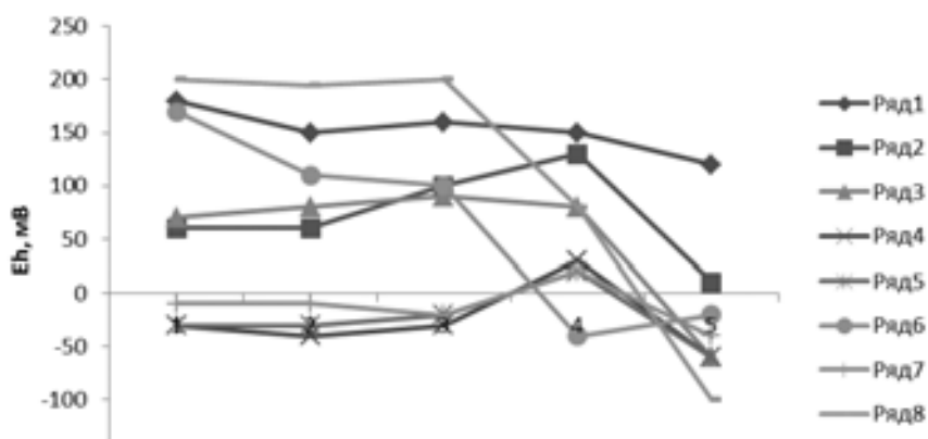
Рис. 1. Сравнительный график окислительно-восстановительного потенциала биореакторов (eH) с подачей кислорода воздуха для моделей 1-8 (ряды 1-8)
